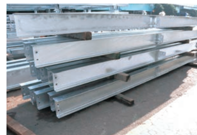
ข้อมสีเงินมันวาวจาก การชุบสังกะสีแบบจุ่มร้อน
