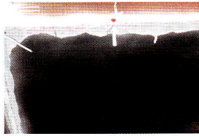
การทดสอบการตรวจหารอยร้าวที่แพ็คเกจซิลด้วยความร้อน
