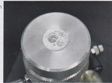
การทดสอบรอยรั่วโดยใช้ฟอง (JIS-Z2329)
